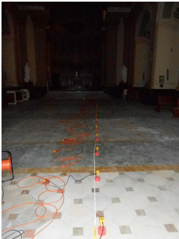
FOTO 1: allineamento della base sismica 1 vista dal punto di scoppio A (ingresso chiesa)
