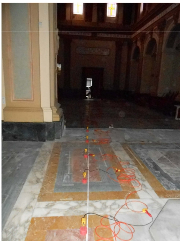
FOTO 2: allineamento della base sismica 1 vista dal punto di scoppio E (altare)
